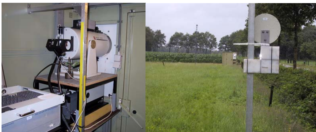
Figuur 5.12 Links de DOAS-telescoop in de meetcontainer, rechts de opstelling in het veld met op de voorgrond de retroreflector en op de achtergrond de meetcontainer. Rechtsboven in de container de uitgezonden lichtbundel.
