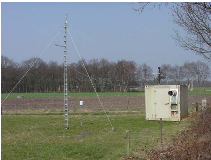
Figuur 2.3 Foto van het tijdelijke meteostation bij het decentrale ammoniakmeetpunt. Op de mast is apparatuur voor meteorologische metingen aangebracht.
