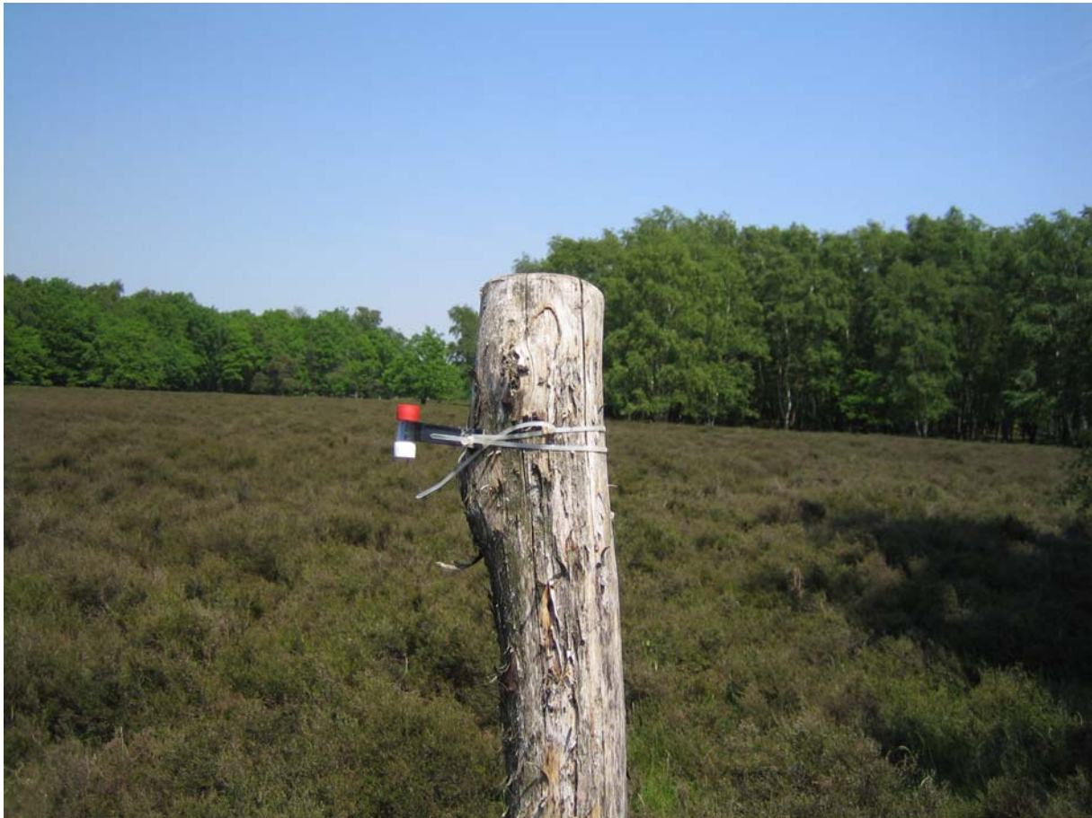
Een passieve sampler in het veld bij Springendal
