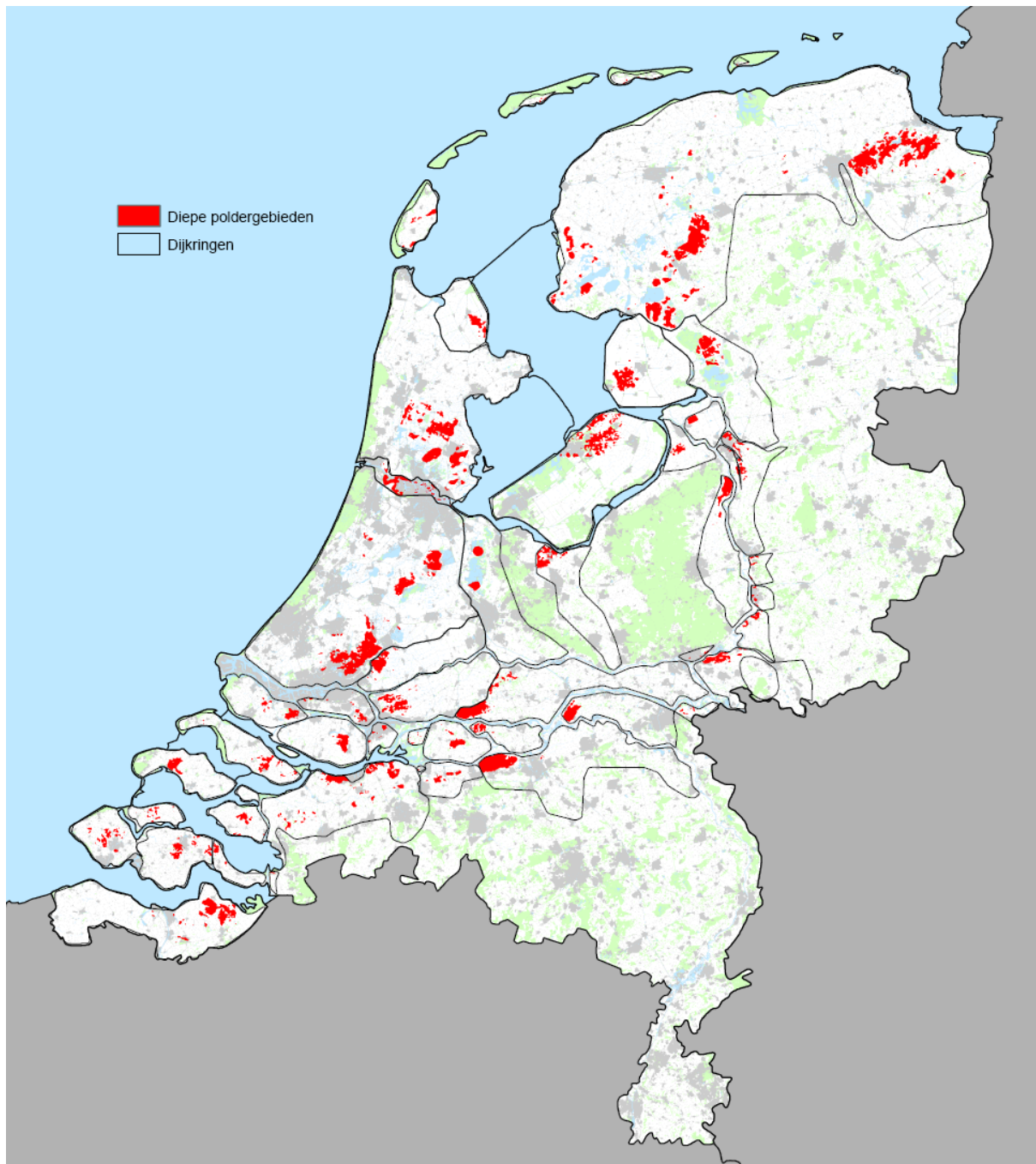
Figuur B8: Diepe poldergebieden bestaande uit 5% diepste delen binnen dijkkringen. Dit is een eerste benadering van gebieden binnen dijkkringen die bij overstroming waarschijnlijk als eerste onder water komen te staan. Er is geen rekening gehouden met de bestaande compartimentering binnen dijkkringen of met de overstromingskansen van de diverse dijkvakken.
