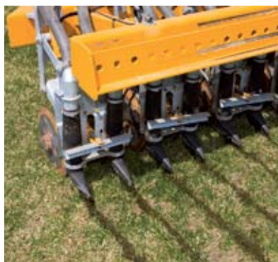
Zodebemester, mest komt een paar centimeter diep in de bodem Foto: Veenhuis bv.
