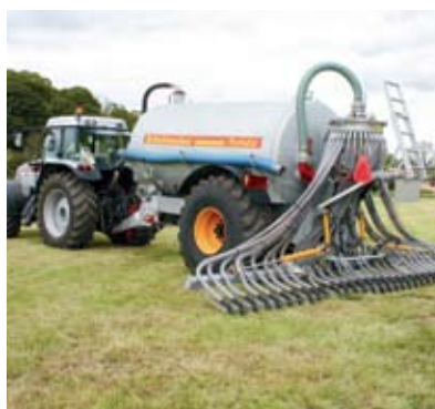
Sleepvoetbemester, mest wordt tussen het gras gedeponeerd Foto: Schuitemaker Machines bv.
