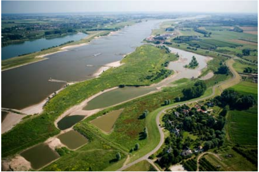
Bij Tiel ligt het natuurontwikkelingsgebied Passewaai. Het gebied kent een strang, amfibiepoelen en dynamische moerassen in de uiterwaard. Als bij hevige regenval de waterstand in de Waal stijgt, kan het wetland onderlopen.
