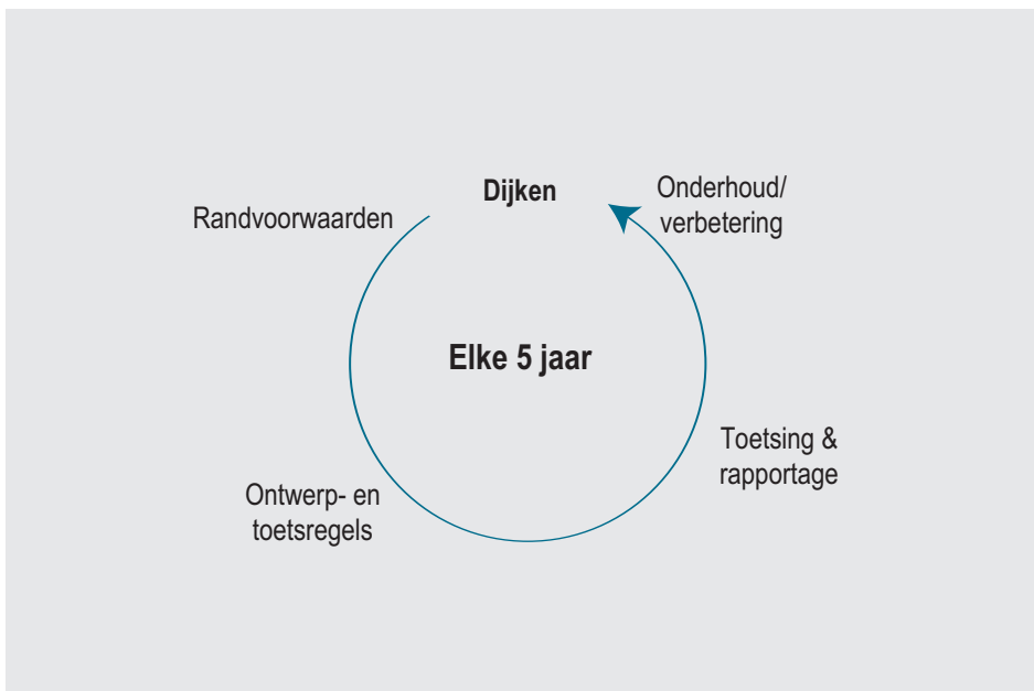
Figuur 2.4.1 De vijfjaarlijkse cyclus van het vaststellen van hydraulische randvoorwaarden en het toetsen van de waterkeringen.
