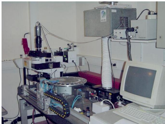
*Figuur 4.1: Opstelling van confocale laser-scan microscoop voor automatische beeldverwerking (Image Analyser).*
