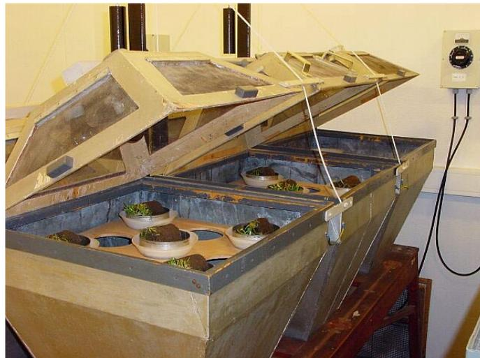
*Figuur 9.1: Tullgrenapparaat voor de extractie van micro-arthropoden. Grondmonsters bevinden zich in de zeffjes op trechters. Monsters worden met gesloten kap van boven verwarmd. De uitgekropen dieren worden onder in de trechter in alcohol opgevangen.*
