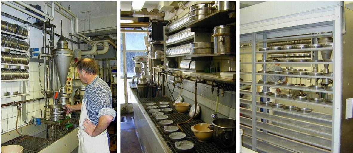
*Figuur 6.2: Stappen in de extractie van nematoden uit grond. Links: Oostenbrinktrechter met een stapel 40µm opvang-zeven, midden: zeeffjes met wattenfilter, rechts extractieschaaltjes in stelling.*
