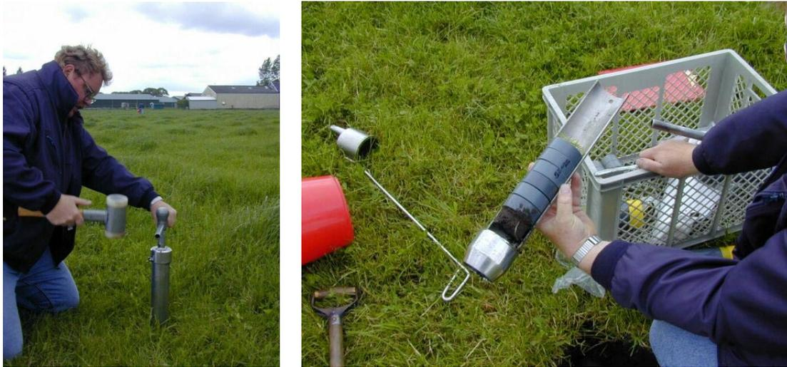
*Figuur 2.3: Deelbare boor met P.V.C-ringen voor het steken van bodemmonsters voor potwormen en micro-arthropoden.*
