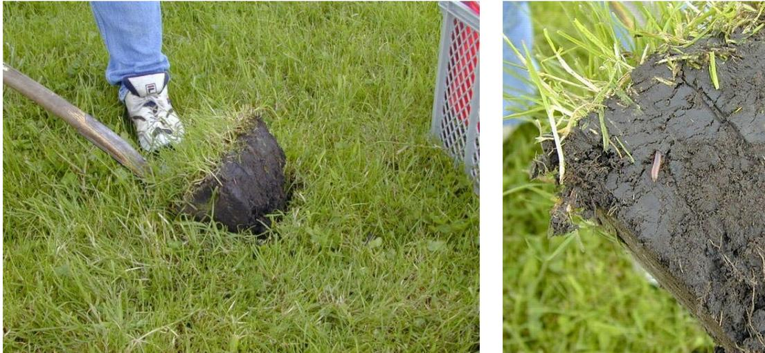
*Figuur 2.4: Het steken van een plag (links) voor analyse van regenwormen in de bodem. Foto rechts detail van een plag met worm.*
