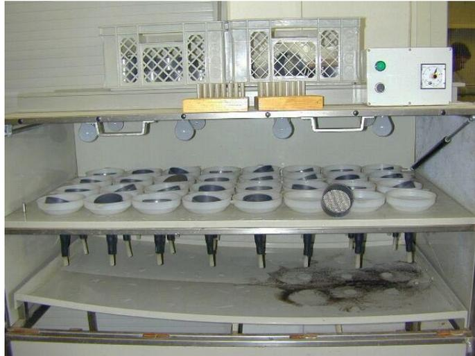
*Figuur 7.1: Extractie-apparaat voor potwormen. Bodemmonsters (schijfjes) worden op een filter in de steunzeefjes gezet. Het zeeffe komt op een trechter met water te staan. De monsters worden aan de bovenzijde verwarmd.*
