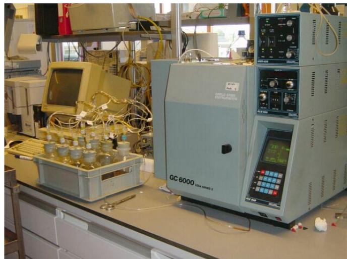
*Figuur 4.3: Foto van opstelling waarmee de respiratie (zuurstofverbruik) wordt gemeten.*
