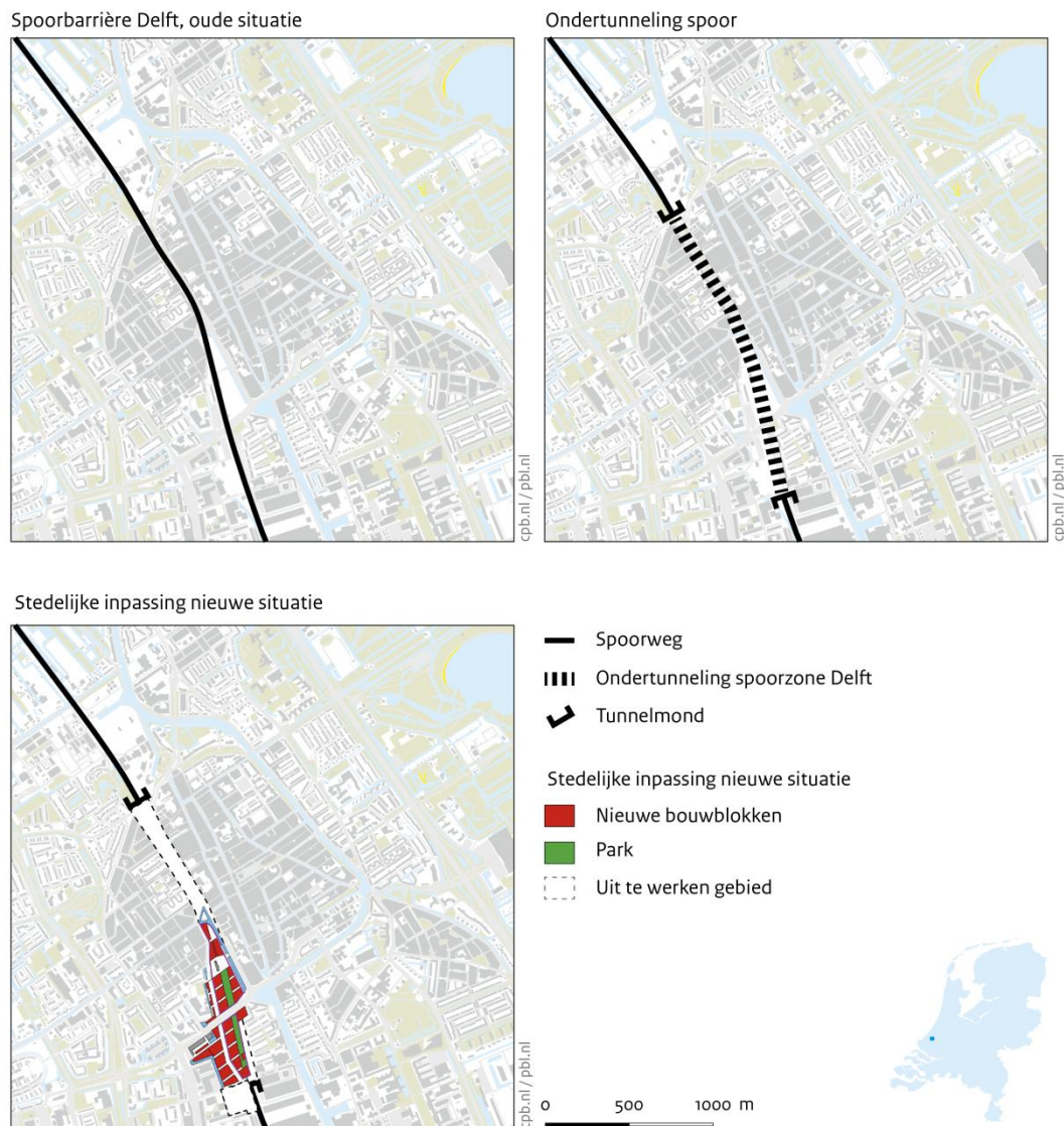
Figuur 3.5 Ontwerp nieuwe spoorzone, Delft (Spoorbarrière, oude situatie; Ondertunneling spoor; Stedelijke inpassing, nieuwe situatie)
