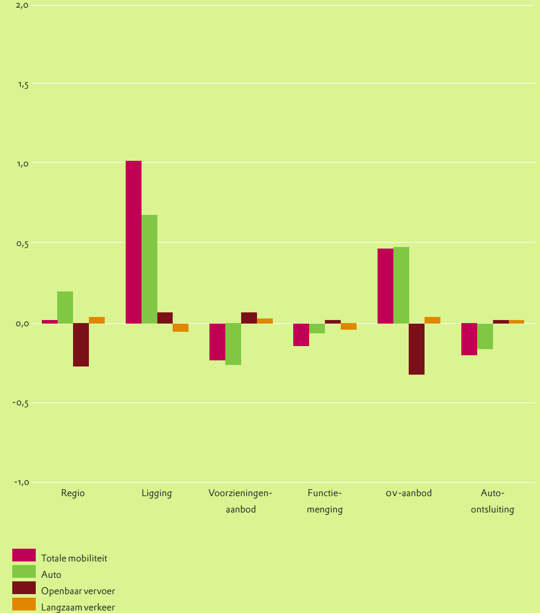
Figuur 26. Bijdrage van verschillende ruimtelijke kenmerken aan verschil in dagelijks afgelegde afstand (in kilometers) per vervoerswijze tussen niet-Vinex-bewoners inbreiding contour 1971 en totale bevolking
