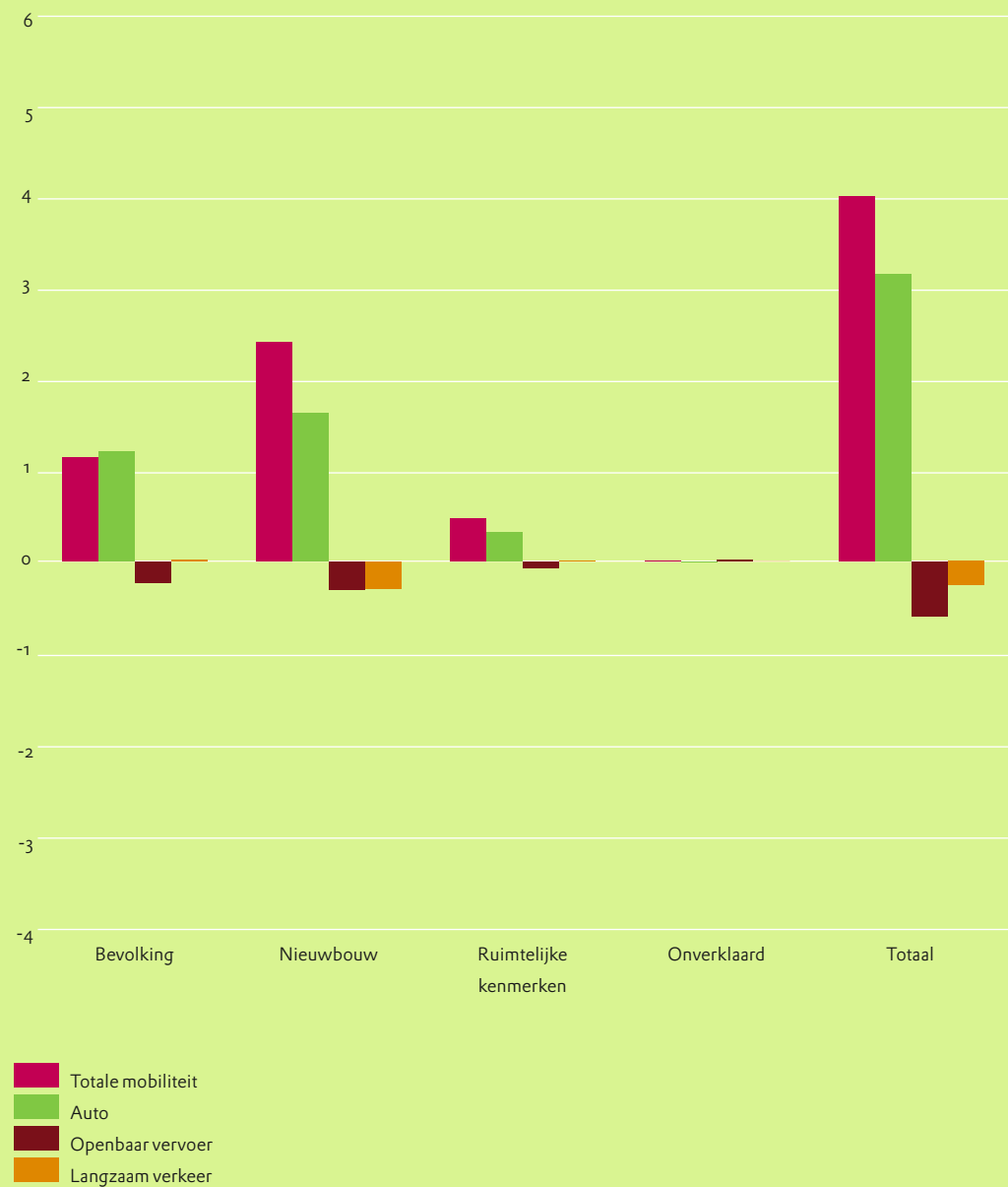
Figuur 15. Bijdrage van verschillende oorzaken aan verschil in dagelijks afgelegde afstand (in kilometers) per vervoerswijze tussen nieuwbouwbewoners en totale bevolking
