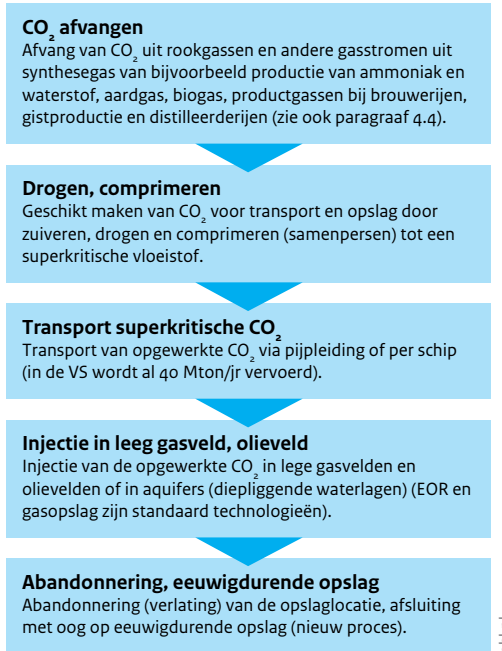
Figuur 4.2 Processtappen bij afvang en opslag van CO 2 (CCS)
