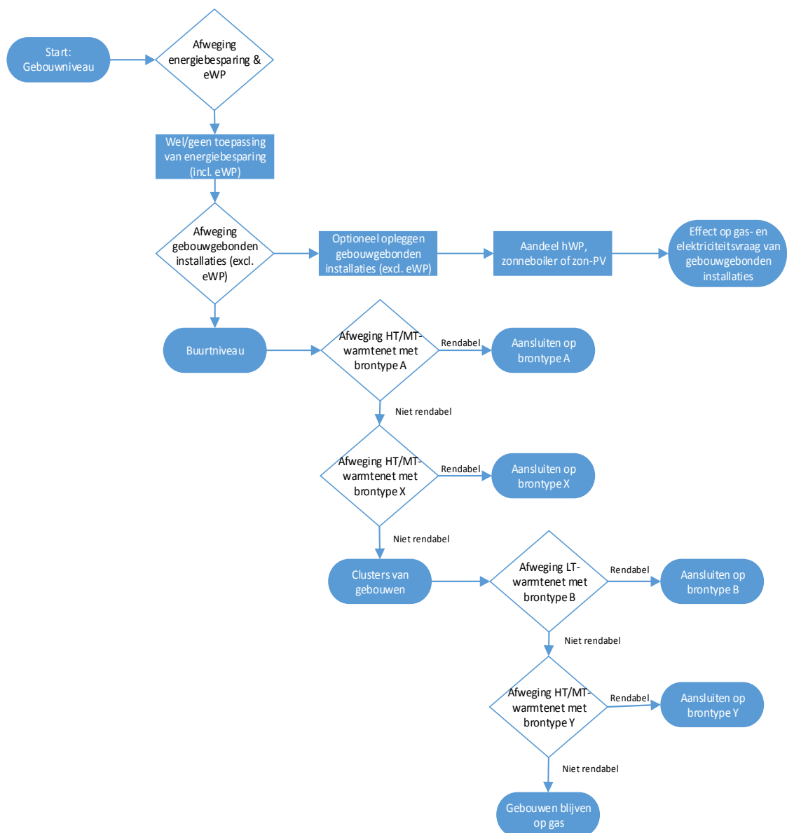
Figuur 16 - Stroomdiagram werkwijze model
