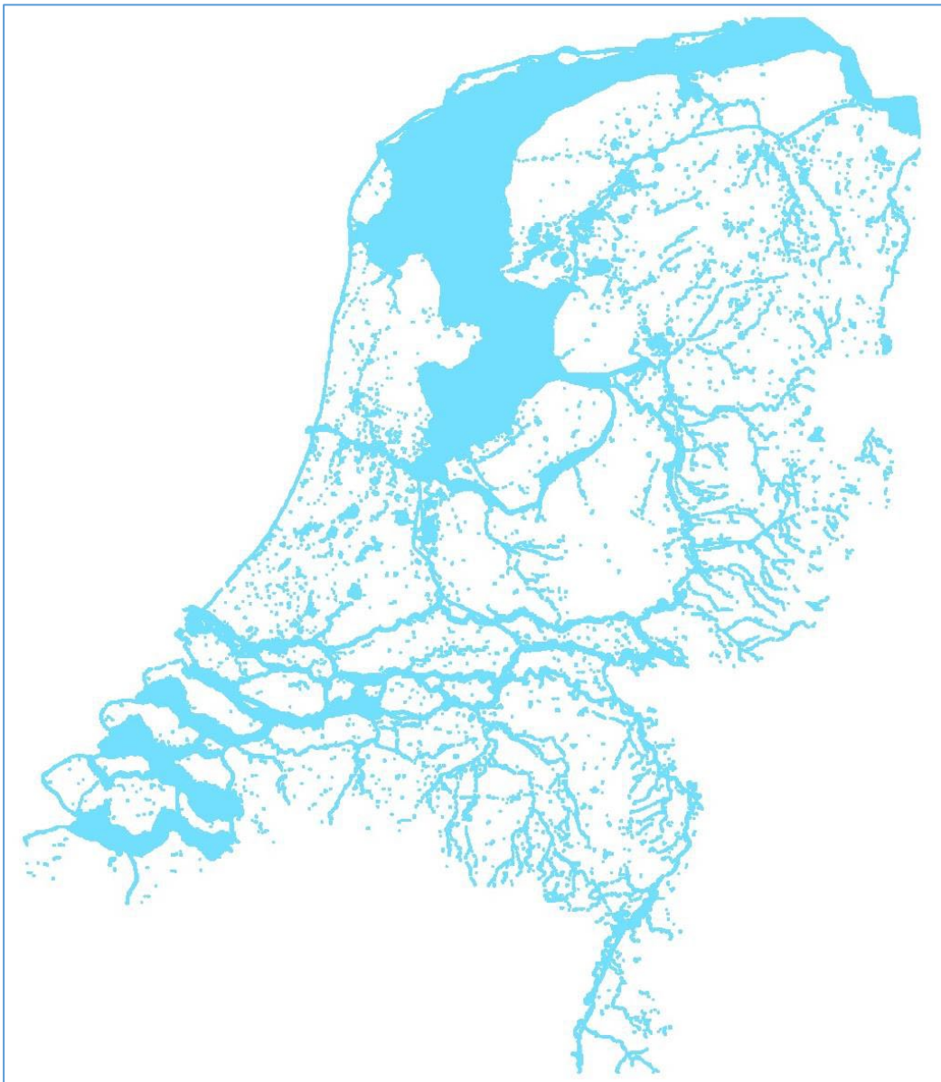
FIGUUR 5.5 – POTENTIEELKAART ENERGIE UIT OPPERVLAKTEWATER. BLAUW GEEFT HET OPPERVLAKTEWATER DAT IN POTENTIE GESCHIKT IS VOOR ONTTREKKING VAN THERMISCHE ENERGIE
