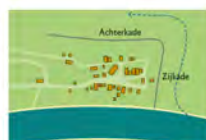
Schematische weergave van de werking voor een dorp van zijkaden en achterkaden.
