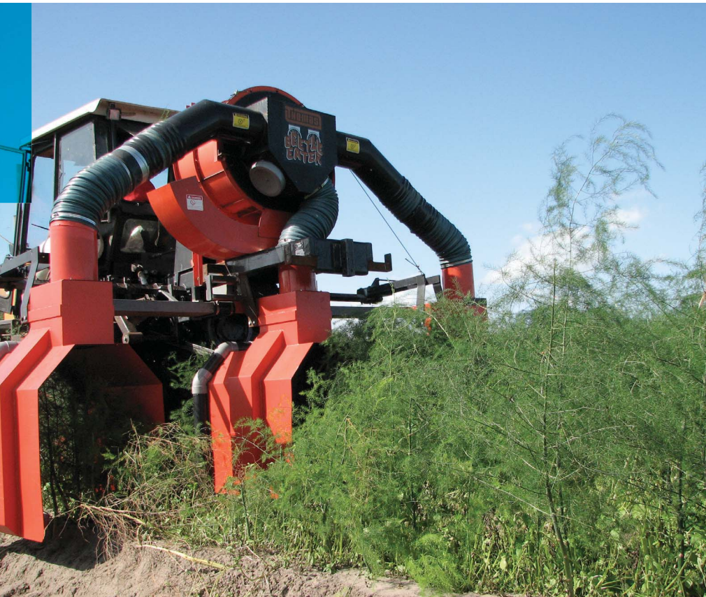
De Beetle eater is een landbouwmachine die, zonder chemische middelen te gebruiken, ongewenste insecten uit gewassen opzuigt
